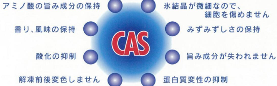
凍結装置内に磁場を発生させて水分子を細かく振動させながら凍結します。十分に温度が下がったら、小さな衝撃を与えて一気に全体を凍らせます。この時できる氷は、微小な氷の粒の集まりなので、細胞膜を傷つけることはありません。解凍してもドリップが出ず、細胞中の水分も失われません。
